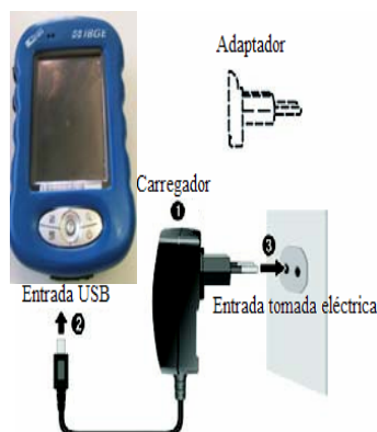
Figura 12: Instruções de como carregar a bateria
