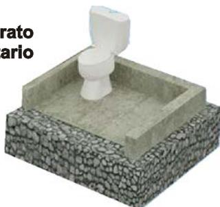
5. **Aparato sanitario:** Artefacto prefabricado destinado a posicionar y brindar comodidad a la persona durante el acto de defecación. Podrá emplearse de tipo taza o de tipo turco (plantillas en la losa para ubicar los pies).
