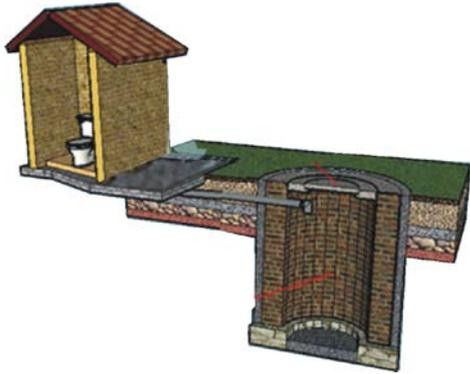
**Arrastre hidráulico:** Cuando las excretas son enviadas, mediante la tracción que produce el agua, **al tanque séptico o biodigestor** seguido de un sistema de infiltración (zanja o pozo).
