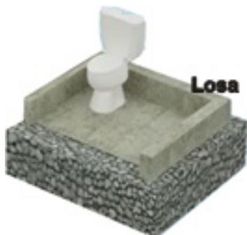
4. **Losa:** Elemento que cubre el hoyo o cámara, soporta a la persona y va instalado sobre el brocal. Podrá ser construido de madera resistente a la humedad, concreto reforzado, plástico, fibra de vidrio o cualquier otro material durable y capaz de soportar el peso de la persona y del aparato sanitario.
