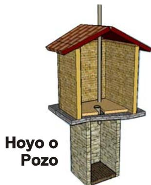
1. **Hoyo o pozo:** Cavidad de una determinada profundidad que se hace en la tierra para depositar las heces humanas, los orines y el material de limpieza.
