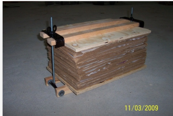
Figura 28. Un mecanismo para prensar con tornillos es menos común, pero muy efectivo.
