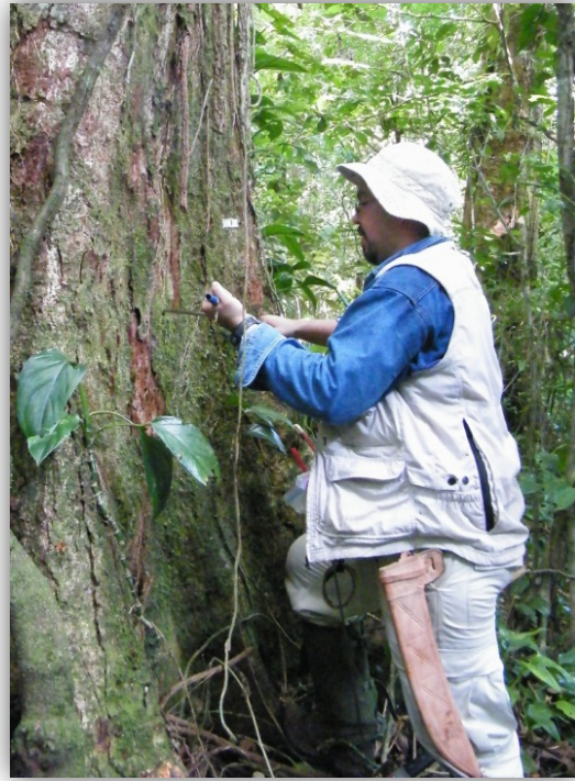
Figura 12. Insertado del barreno de Pressler a la altura del pecho (1.3 m). (Esquema modificado de Jozsa, 1988)
