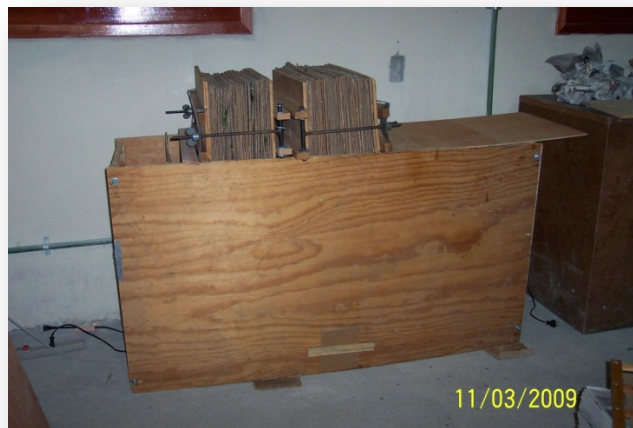
Figura 29. Secadora de ejemplares de herbario con focos eléctricos como fuente de calor.
