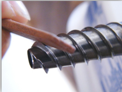
Figura 8. Afilado de espiral de la punta roscada. El afilado se realiza por los dos lados con la piedra ahusada en un ángulo de 45^\circ con el filo de la espiral.
