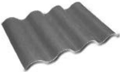
**Fibrocemento:** es un material hecho a base de una mezcla de cemento comprimido en láminas de diversos tamaños y formas. Generalmente lo encontrará en forma de teja o en láminas onduladas. Es del mismo material del FIBROLIT o PANELEX pero de menor grosor. Además se incluye aquí el denominado asbesto-cemento (Ricalit).
