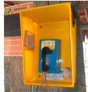
**Teléfono público tarjetero.-** Un teléfono tarjetero, para el caso de telefonía pública, es aquel aparato telefónico que no admite el uso de monedas ni de tarificadores (locutorios), solo puede ser utilizado con tarjetas telefónicas. El uso de estas tarjetas es similar a las tarjetas de recarga celular, es decir hay que ingresar los 10 códigos o más que traen estas tarjetas pero con la diferencia que se tiene que realizar por cada llamada hasta que se acabe el saldo.
