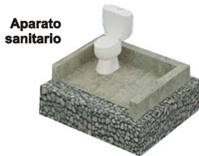
**5. Aparato sanitario:** Artefacto prefabricado destinado a posicionar y brindar comodidad a la persona durante el acto de defecación. Podrá emplearse de tipo taza o de tipo turco (plantillas en la losa para ubicar los pies).
