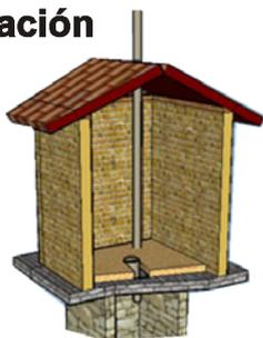
**7. Tubo de ventilación:** Conducto que se coloca para evitar malos olores y el ingreso y salida de moscas y otros insectos.
